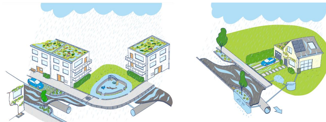
Figuur 14. Extreme neerslag: gecontroleerd overstroomen © Aquafin.
