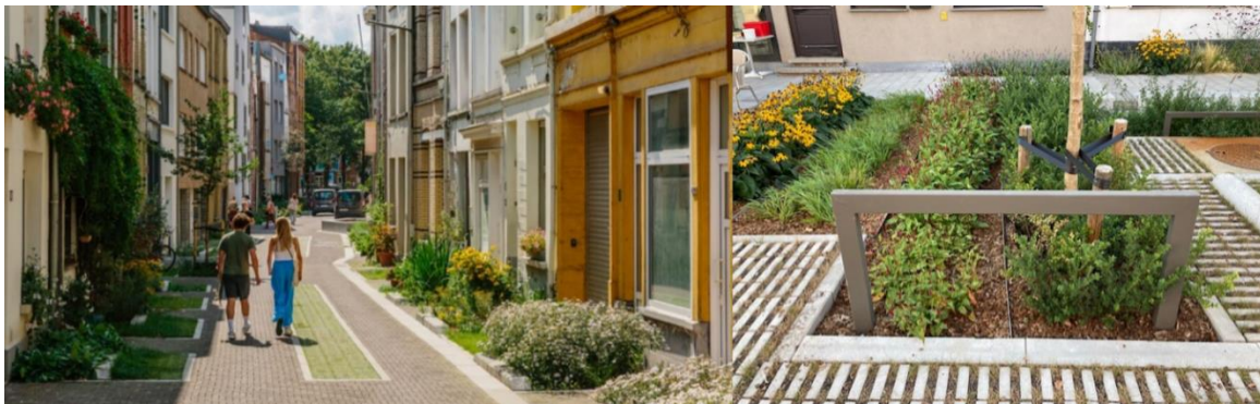
Figuur 22. Vlnr: (1) Ontharding met boven- en ondergrondse infiltratie in centrum Antwerpen. © Aquafin; (2) Infiltrerende plantvakken in Aziëlaan (tuinstraat Wilrijk). © Aquafin
